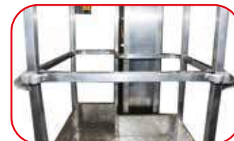
Ingresso cestello con barra a caduta
